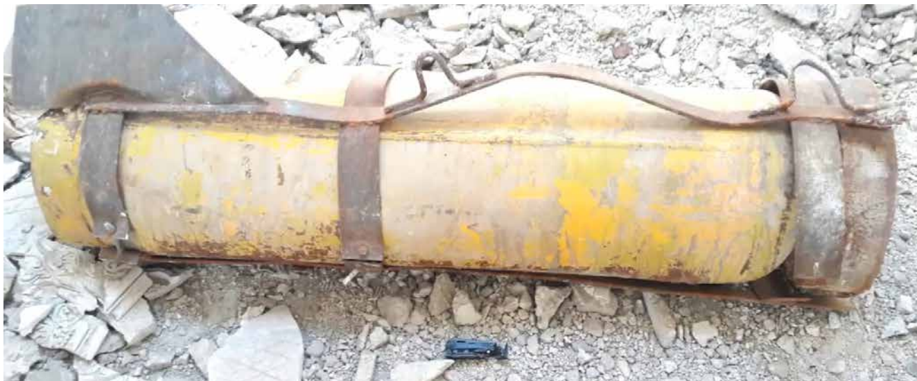
Remains of a modified chlorine cylinder with an external metal structure (Source - لسعلا ناخ قنيدم يف ماسلا رولللا زاغ يوحى ليجرب قلازا - يروسلا يندملا عافدلا ليق نم يبرغلا بلح فيرب بلدا تظفاحم يف يروسلا يندملا عافدلا, YouTube, uploaded by عافدلا يندملا عافدلا, August 25, 2017, https://www.youtube.com/watch?v=o5ZeRxyz4h ).
